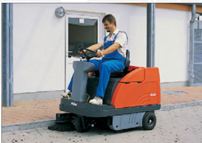
Hako-Jonas 980 V: Für den Außeneinsatz mit hydrostatischem Fahntrieb und drehzahlgeregeltem Benzinmotor. Kaltstart auch bei Minustemperaturen.
