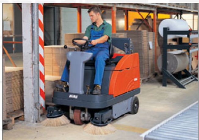
Hako-Jonas 980 E: Für den abgasfreien Inneneinsatz mit elektrischem Fahntrieb und unterschiedlichen Batteriesystemen. Bis zu 4,5 Stunden Laufzeit.
