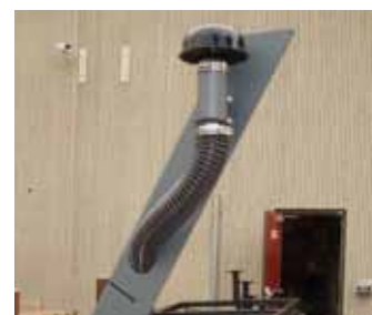
MEGEMELT LEVEGŐ SZŰRŐ A motor által beszívott levegőt a magasból nyerjük. A nehéz ipari körülmények közt alkalmazzuk
