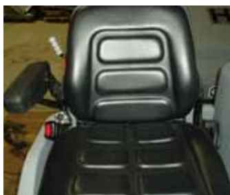
ÁLLÍTHATÓ ÜLÉS A kezelő súlyához igazítható kényelmes vezetőülés
